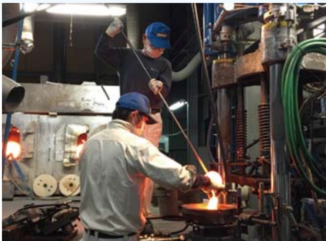
1200度の液体状のガラスを扱う職人技が岡本硝子を支えている(巻き手は社歴50年を超え、ガラスばさみを持つ若手は30代)
