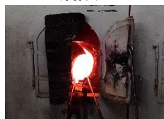
ガラスの原料を溶かします
