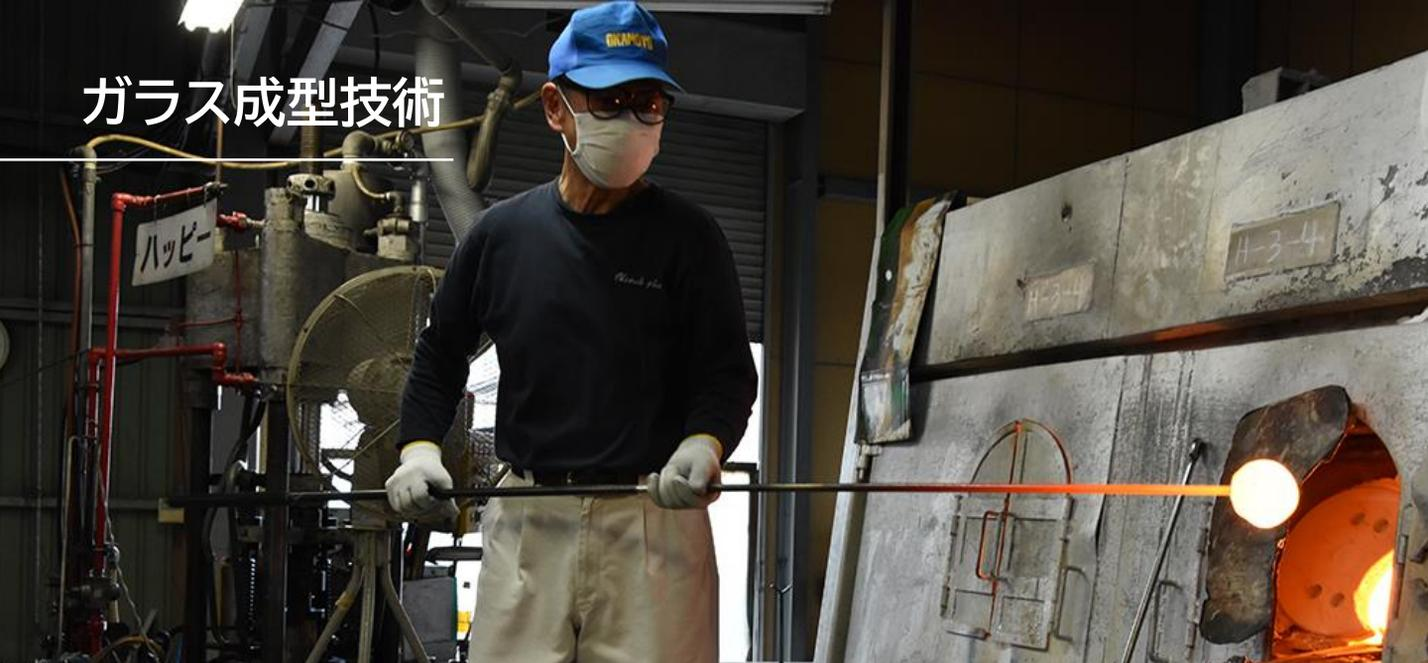
岡本硝子のガラスプレス成型は、ダイレクトプレスと言い、連続成型機にて溶けたガラスを連続的にプレス成型することが可能なため、材料の再加工も必要なく、安価な大量生産が可能です。研磨加工では作ることが難しい深型の形状製品・大型製品にも適しています。
