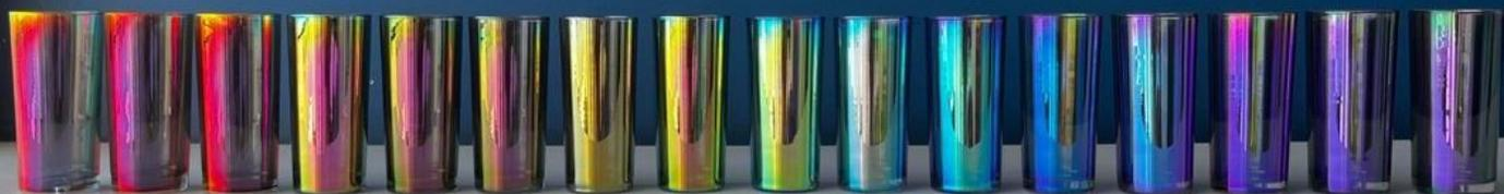
蒸着技術は、高真空中で蒸着材料を加熱し、蒸発した材料が基板に付着することにより、薄膜が形成される技術です。光学製品や加飾用途に使われています。
