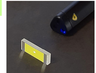
青色レーザー光がガラス封止蛍光体を通過すると白色光となる。
