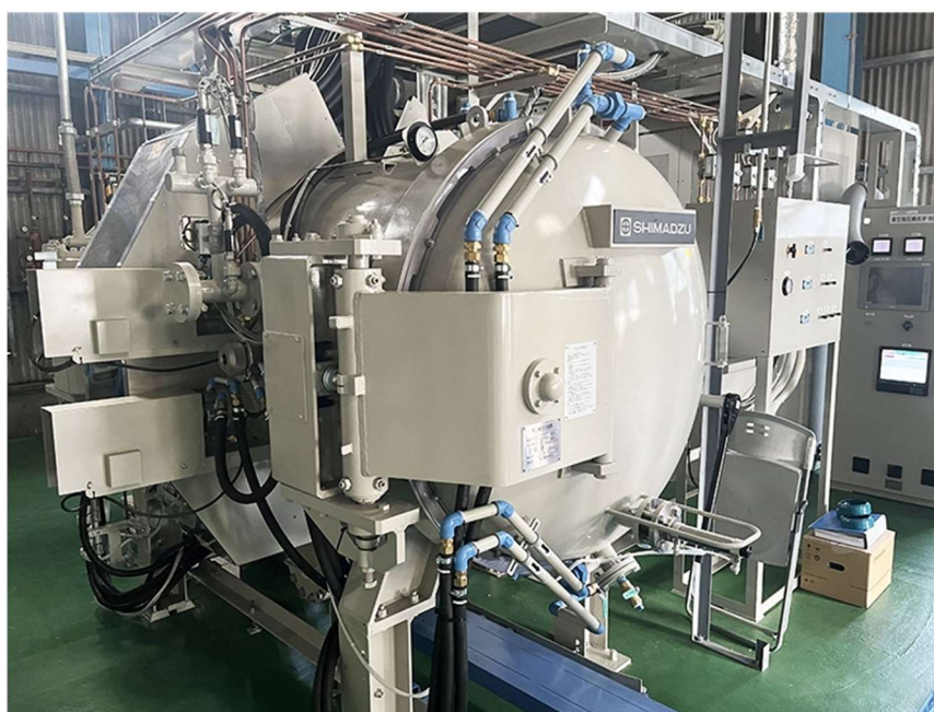
(岡本硝子社) AlN基板の焼成炉、月産30,000枚の生産が可能
