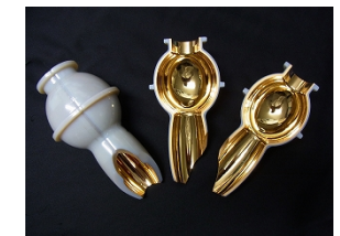
CVD装置用ガラス製反射鏡の断面写真
